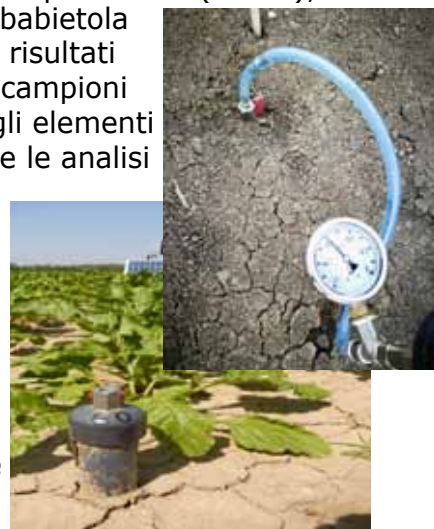
Foto 1 e 2. Sonde di suzione posizionate in campo
