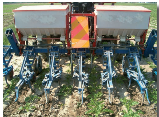
Foto2 - Macchina sarchiatrice. Questo tipo di attrezzatura va utilizzato entro le 6-8 foglie vere. Durante tale operazione è opportuno completare la concimazione azotata.
