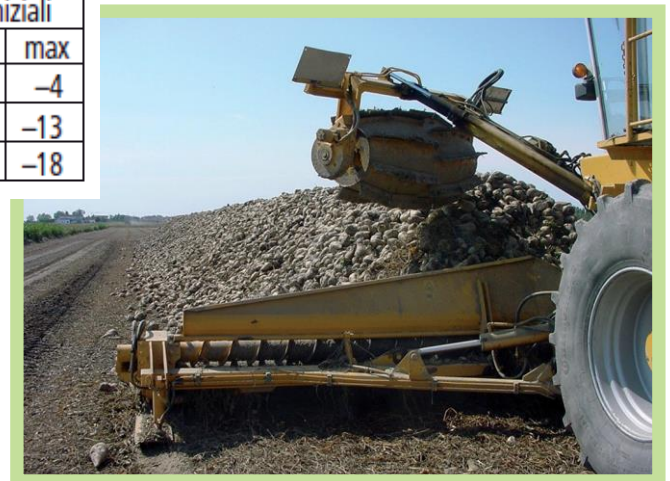
Foto 3. Caricatore-sterratore in azione: se lo si utilizza il cumulo dovrà essere dimensionato in base alla sua dimensione operativa
