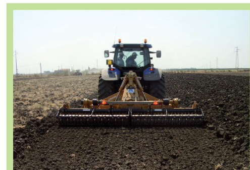
Lavorazione di affinamento con erpice per ridurre la zollosità del terreno
